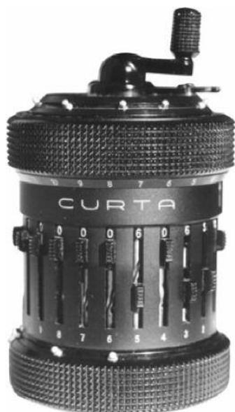
L'utilisation en est très semblable à celle de la machine précédente, la seule différence étant que la soustraction s'obtient non pas en tournant la manivelle à l'envers, mais en la soulevant de 3 mm.
