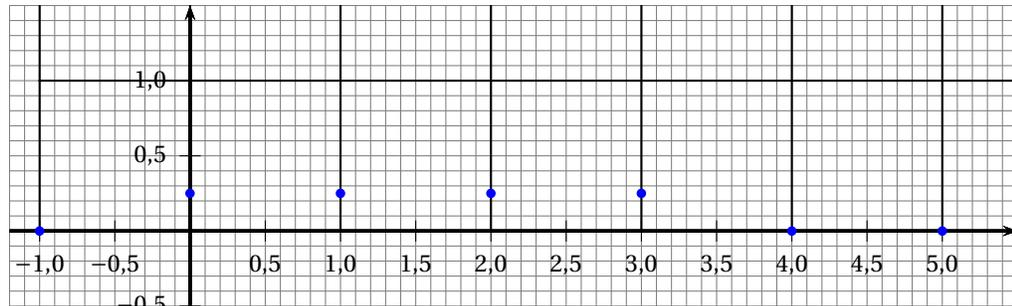
On peut vérifier, dans ce cas, qu'une impulsion de 1 en entrée se retrouve divisée par 4 en sortie. En réalité le moyennage s'effectue sur 100 échantillons, l'impulsion de 1 en entrée est alors divisée par 100.
